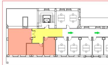
**MODIFICA AI PERCORSI PER L'ESODO IN EMERGENZA AL PIANO 7° DURANTE I LAVORI PER LA COSTRUZIONE DEL NUOVO FILTRO A PROVA DI FUMO - SCALA "A"**
