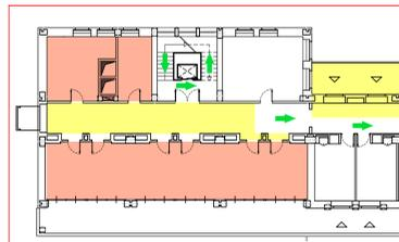
**MODIFICA AI PERCORSI PER L'ESODO IN EMERGENZA AL PIANO 6° DURANTE I LAVORI PER LA COSTRUZIONE DEL NUOVO FILTRO A PROVA DI FUMO - SCALA "A"**
