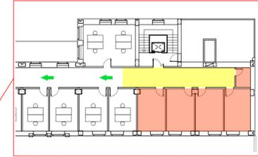
**MODIFICA AI PERCORSI PER L'ESODO IN EMERGENZA AL PIANO 7° DURANTE I LAVORI PER LA COSTRUZIONE DEL NUOVO FILTRO A PROVA DI FUMO - SCALA "D"**
