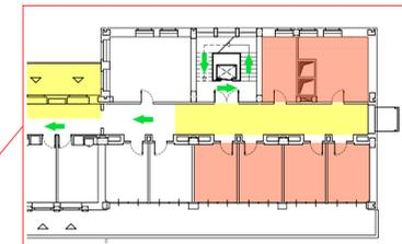
**MODIFICA AI PERCORSI PER L'ESODO IN EMERGENZA AL PIANO 6° DURANTE I LAVORI PER LA COSTRUZIONE DEL NUOVO FILTRO A PROVA DI FUMO - SCALA "D"**
